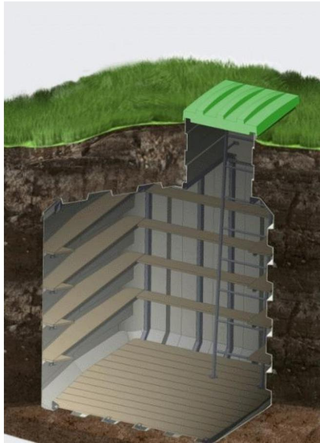
В течении нескольких недель после монтажа полиэтиленовые стенки погреба под воздействием грунта прижимаются к каркасу и полкам погреба, на больших промежутках допускается незначительный прогиб стенок внутрь погреба.
